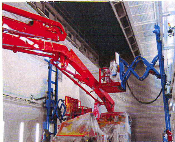
◀ Mittels zweier dreidimensional verfahrbarer Hebebühnen können die Lackierer alle Bereiche sicher und ergonomisch erreichen ▼
