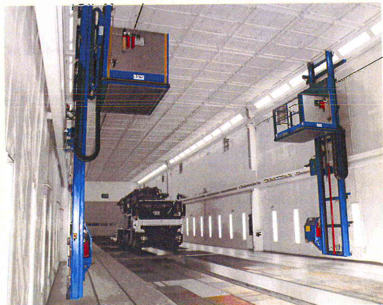
◀ Mittels zweier dreidimensional verfahrbarer Hebebühnen können die Lackierer alle Bereiche sicher und ergonomisch erreichen ▼
