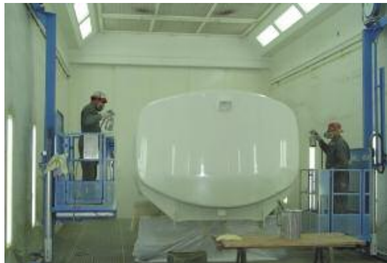
Kombinierte Farbspritz- und Trockenkabine, vertikalbelüftet mit Großflächenfilterdecke. Pneumatische Hebebühne für die Arbeitserleichterung.
