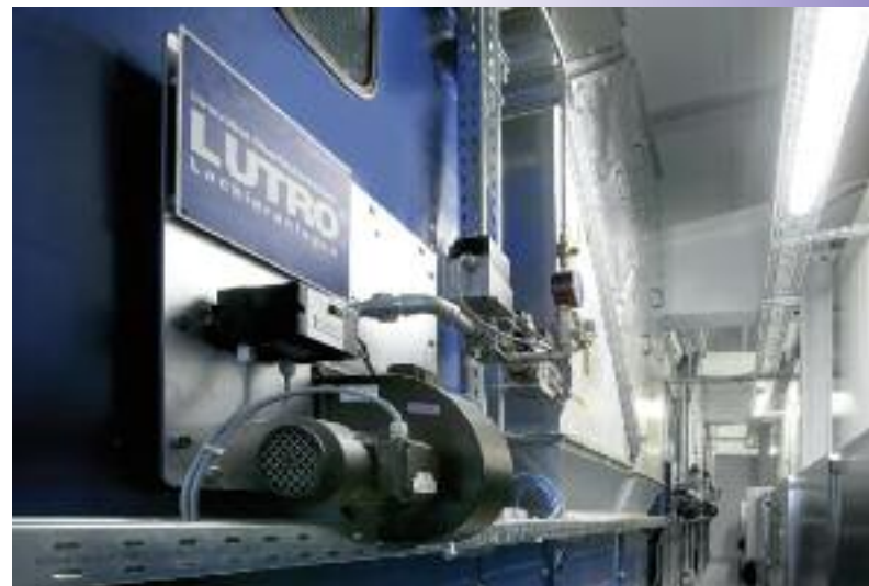
Luftapparaturen sind mit Gasflächenbrenner, Wärmerückgewinnung und Frequenzsteuerung besonders energiesparend.
