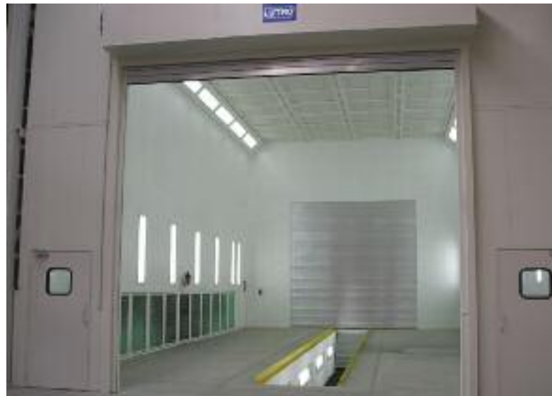
Kombinierte Farbspritz- und Trockenkabine, vertikalbelüftet durch Großflächenfilterdecke mit seitlicher Absaugung überflur und mittlerer Absaugung in der Arbeitsgrube unterflur.
